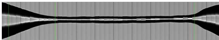
Рис. 1. Профиль волоконных конусов с перетяжкой 20 мкм и длиной 40 мм.
