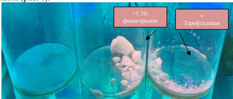
Рис. 1 Люминесценция аэрогелей в УФ-камере (основная полоса источника 312 нм).
