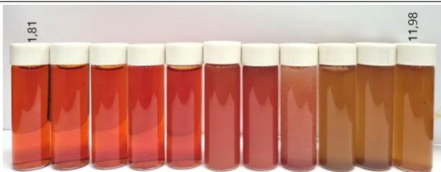
Рис. 2. Фотография растворов наночастиц селена, стабилизированного кокамидопропиламинооксидом, с различными значениями pH буферного раствора
