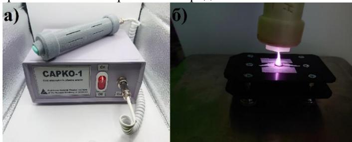
Рис. 1. источник низкотемпературной плазмы САРКО (а), аргоновая струя САРКО (б).
