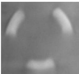
Рис. 1. Фотография торца сегментированного спирального волновода.
